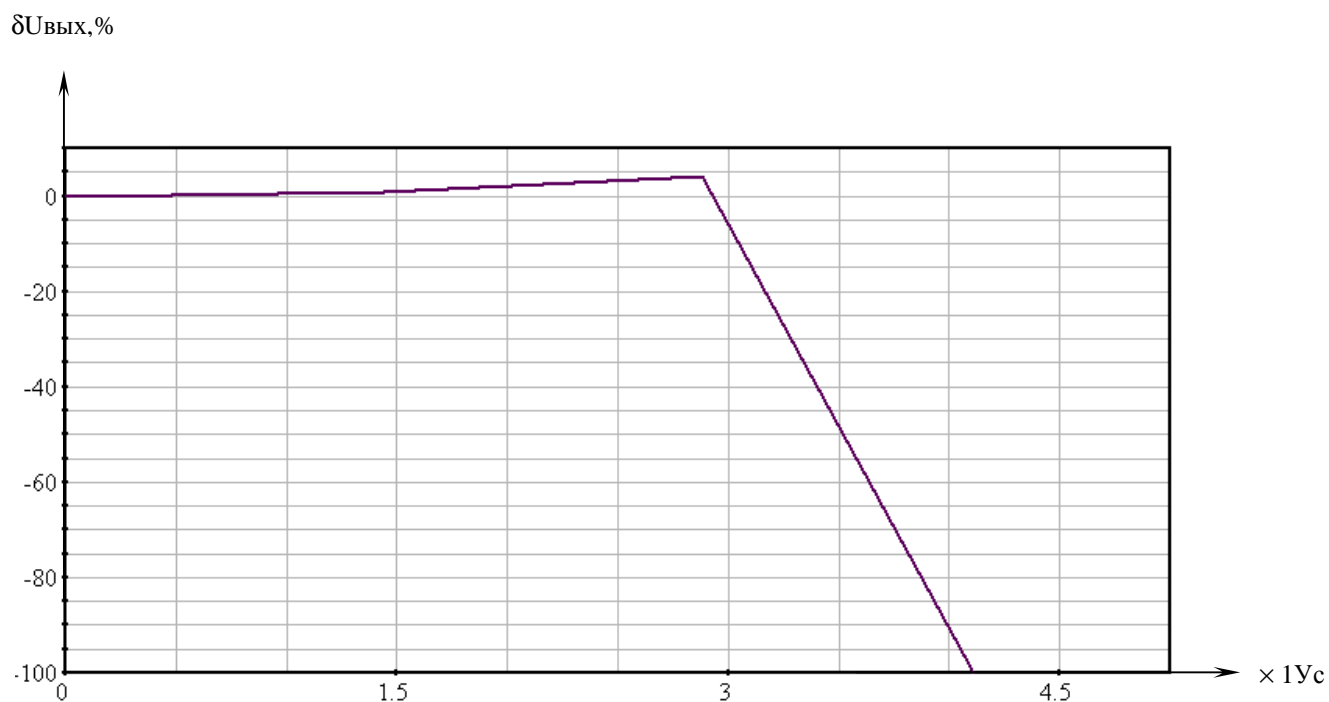
Рисунок Ж.1 – Зависимость изменения выходного напряжения при воздействии фактора 7.И с характеристикой 7.И 1
